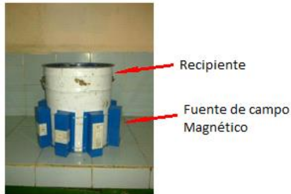
Figura 1: Recipiente donde se prepara la semilla y fuente de campo magnético utilizada.
