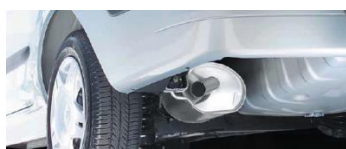
Acero ACE 439A aplicado a un dispositivo de escape
