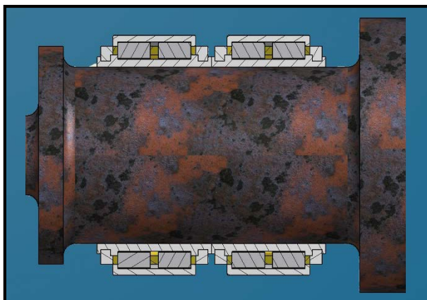
Fig. 12: Solución de apoyo propuesta para los molinos de caña 17
