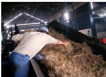
Figura 1. Muestreo de caña preparada
