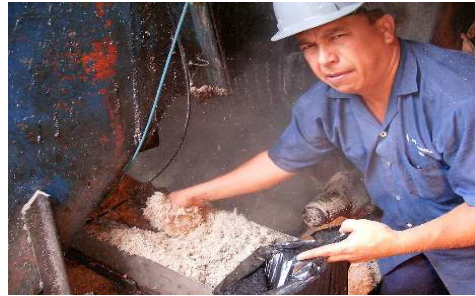
Figura 3: Muestreo de bagazo
