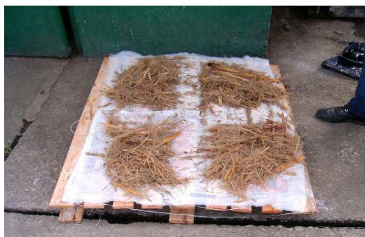
Figura 2. Cuarteo de la muestra caña
