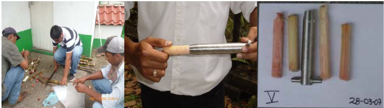
Figura 3. Extracción de la parte interna del entrenudo con el horador metálico.
