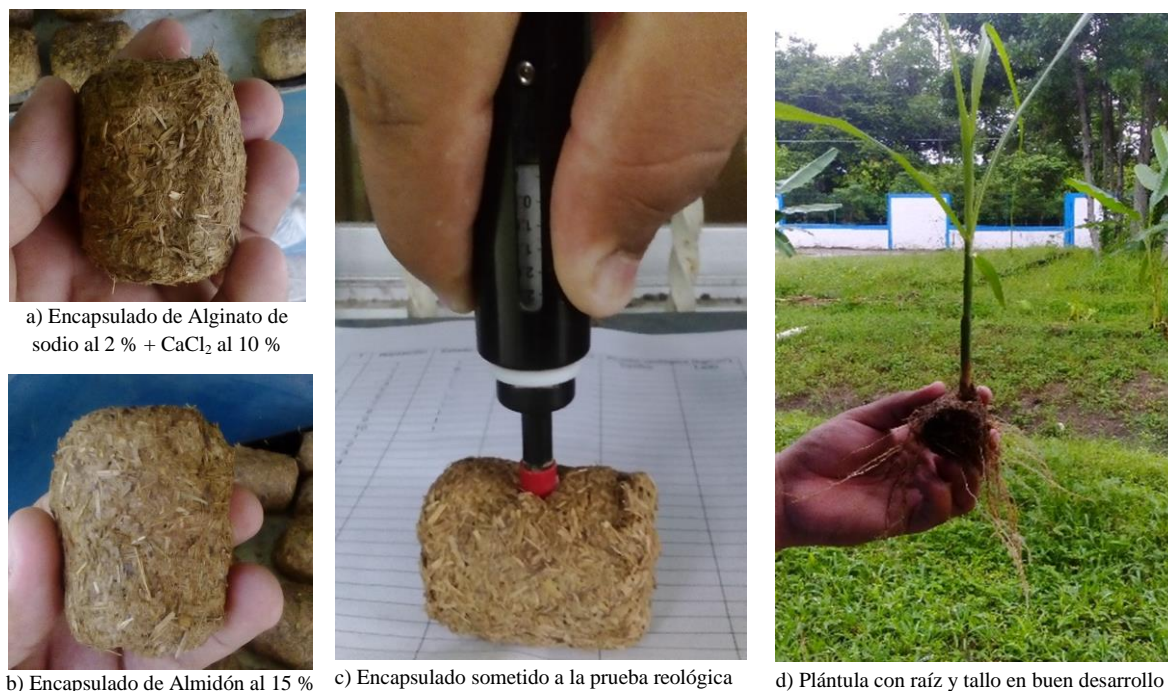
Figura 1. Detalle de encapsulados después de 72 horas de reposo, prueba reológica y germinación.
