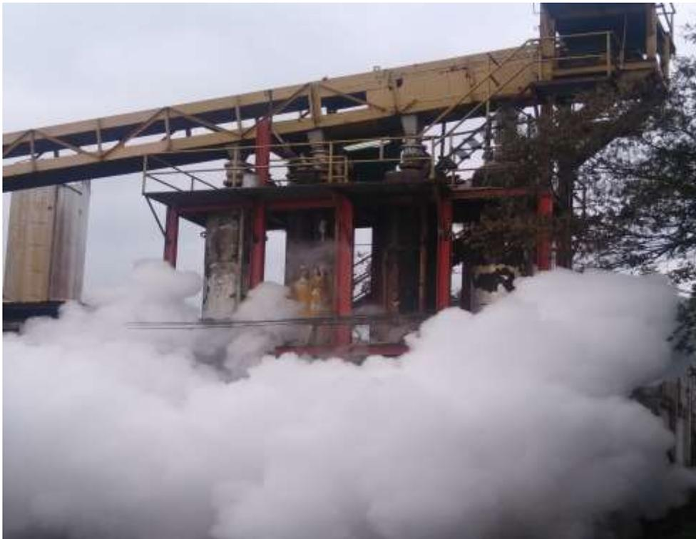
Figura 2. Planta para hidrolizar bagazo
