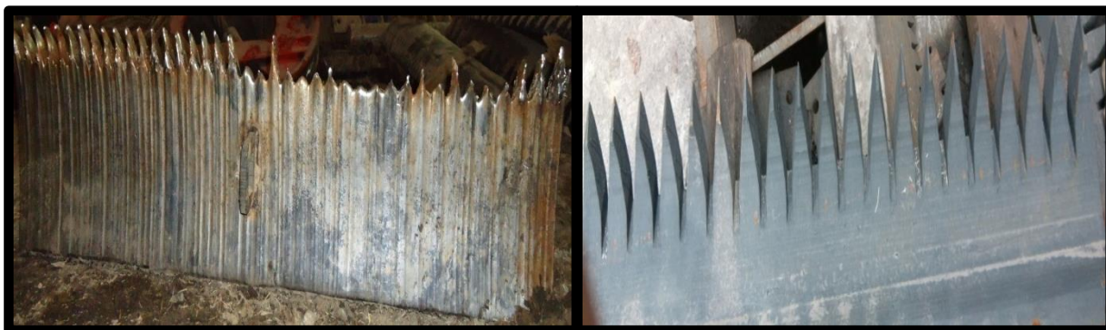
Figura 4. A la izquierda cuchilla central desgastada por exceso de tierra, a la derecha cuchilla central nueva.
