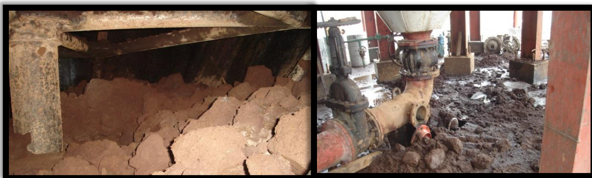
Figura 6. A la izquierda Tierra en el interior del clarificado tipo Wabinda, a la derecha tierra desalojada por el cono inferior del clarificador tipo Wabinda
