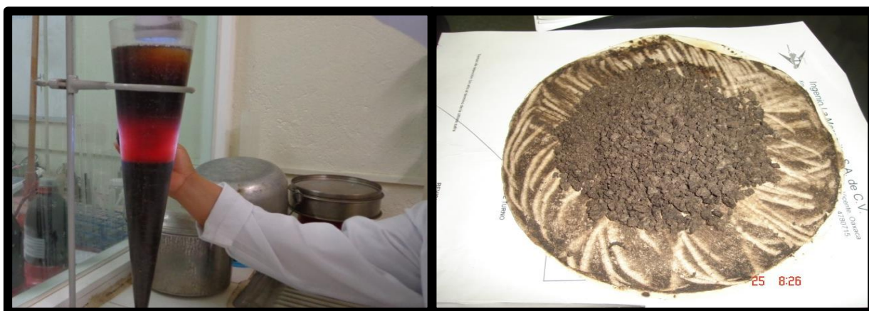
Figura 7. A la izquierda medición en un cono de sedimentación de la tierra presente en el jugo mezclado, a la derecha cantidad de tierra obtenida base seca en un litro de jugo mezclado misma que fue del 2.5 % en peso.
