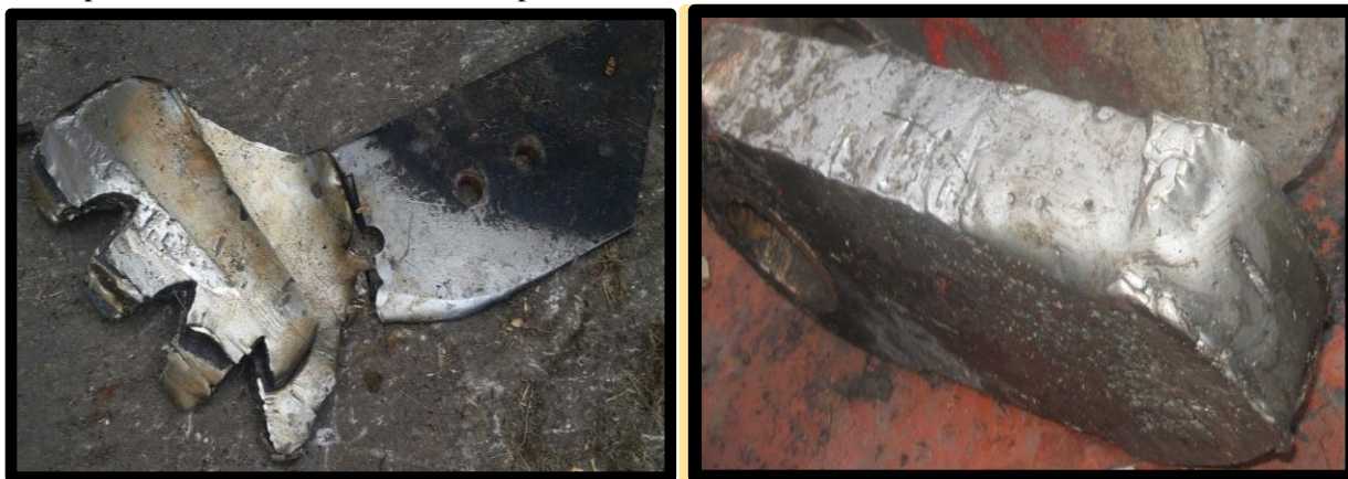
Figura 3. A la izquierda machete del segundo juego de cuchillas fracturado y desgastado por el exceso de tierra, a la derecha se observa un martillo de la desfibradora con desgaste.
