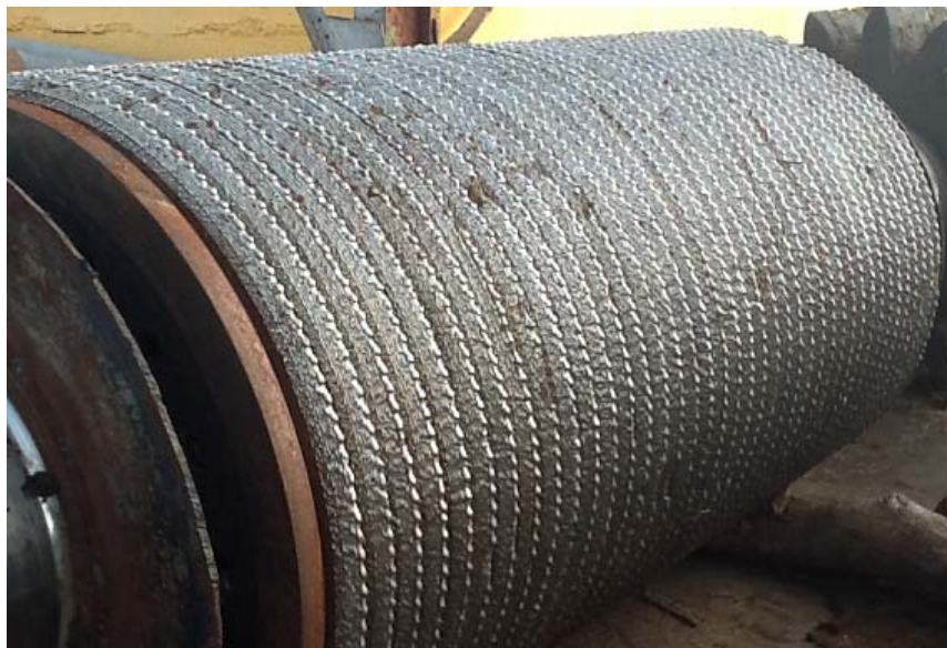
Figura 7. Maza cañera XM paso 2" molino 6
