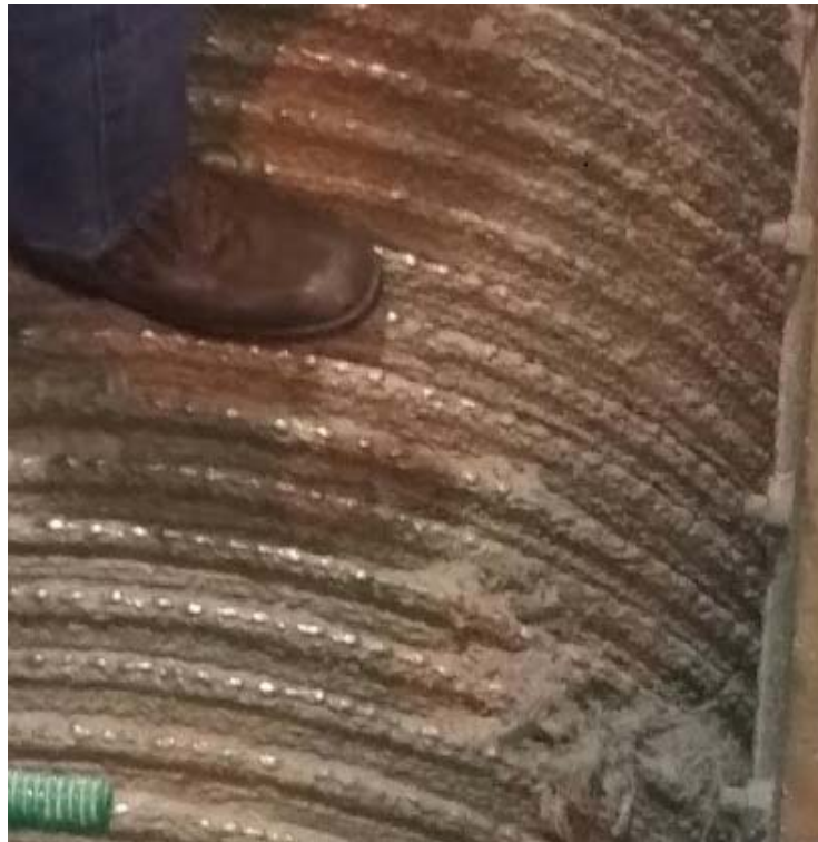
Figura 4. Maza superior XM en hierro dúctil
