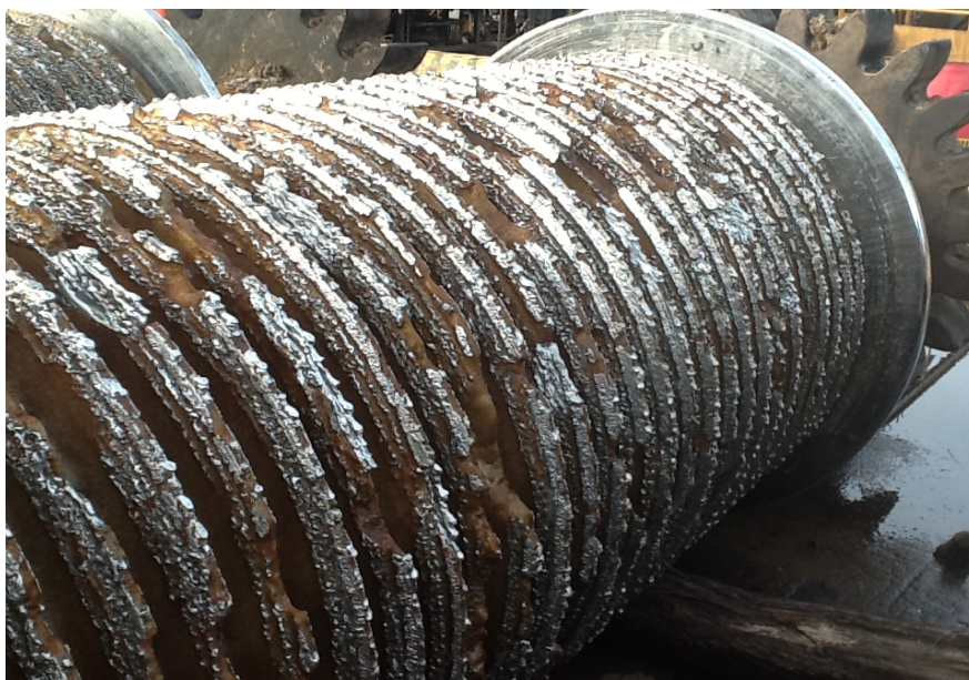
Figura 1. Maza con desgaste y dientes rotos
