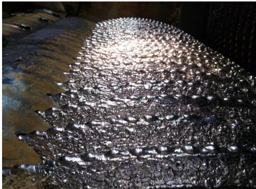
Figura 3. Maza bagacera en hierro dúctil con más de 2 000 000 de toneladas
