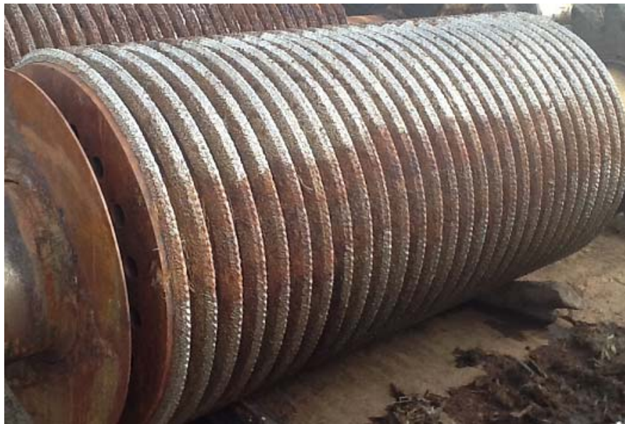
Figura 6. Maza cañera XM paso 3" molino 1
