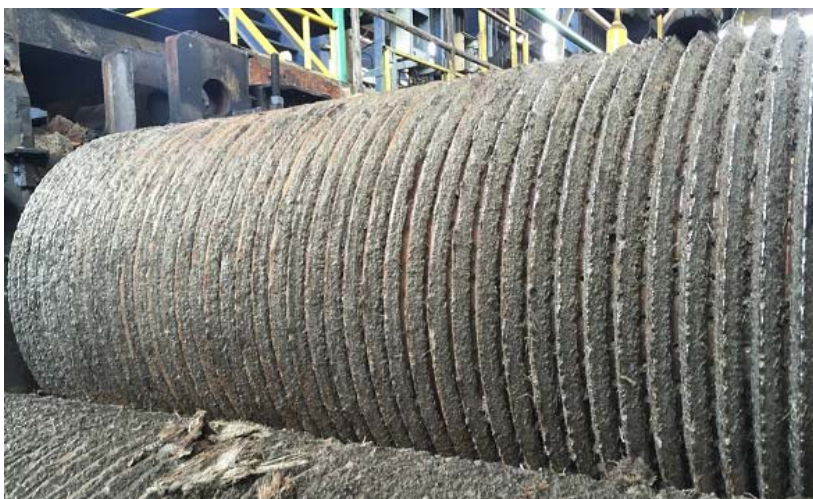
Figura 8. Maza superior XM con casi 2 800 000 toneladas
