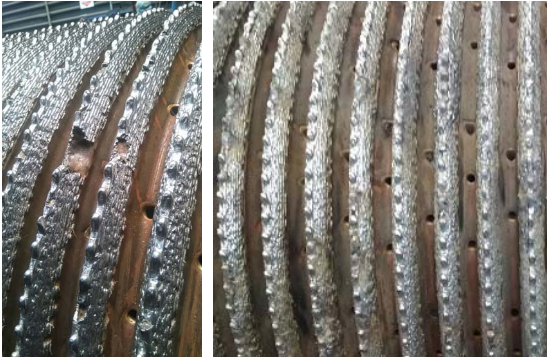
Figura 5. Maza superior despues de cinco meses de molienda
